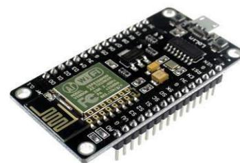
Fig 2: ESP8266 NodeMCU
