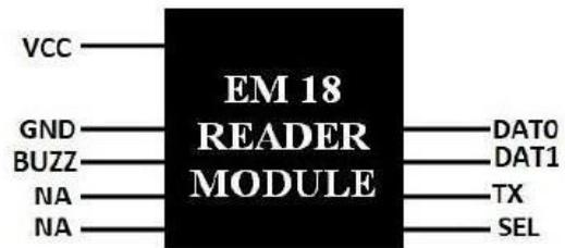
**Fig 4: EM 18 RFID Reader Module**
